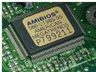
Est destinée uniquement à être lue ; en revanche, son contenu n'est pas altéré par une coupure de courant, c'est une mémoire « rémanente ».
